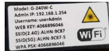
Il y a par défaut **deux SSID** (nom de Wifi) diffusés par la Box sur deux normes différentes : **802.11n** (en 2.4 Ghz) et **802.11ac** (5Ghz). Les deux SSID utilisent la **même clé WPA** (ligne WPA PSK) comme code du Wifi.
